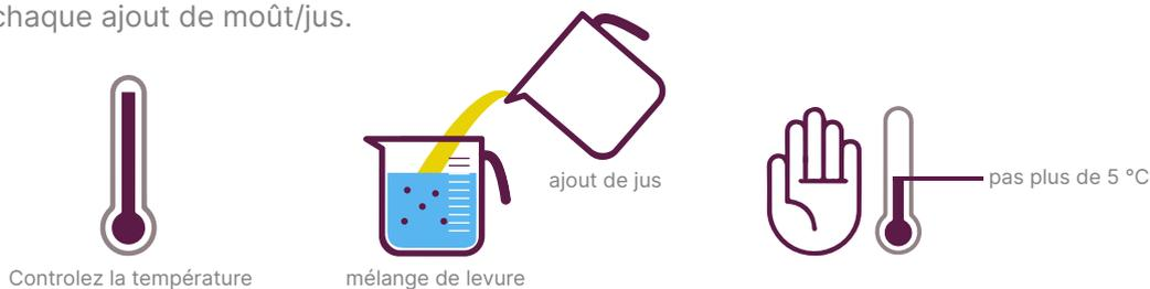
4. Lorsque la température de la suspension de levure est supérieure de moins de 10 °C à celle du moût ou du jus à inoculer, ajouter lentement le mélange de levure dans la cuve de fermentation.
